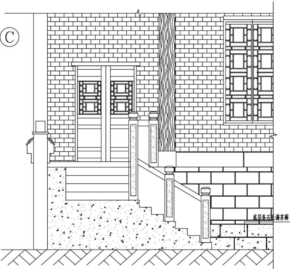
室外转角石台阶剖面图 1:30
