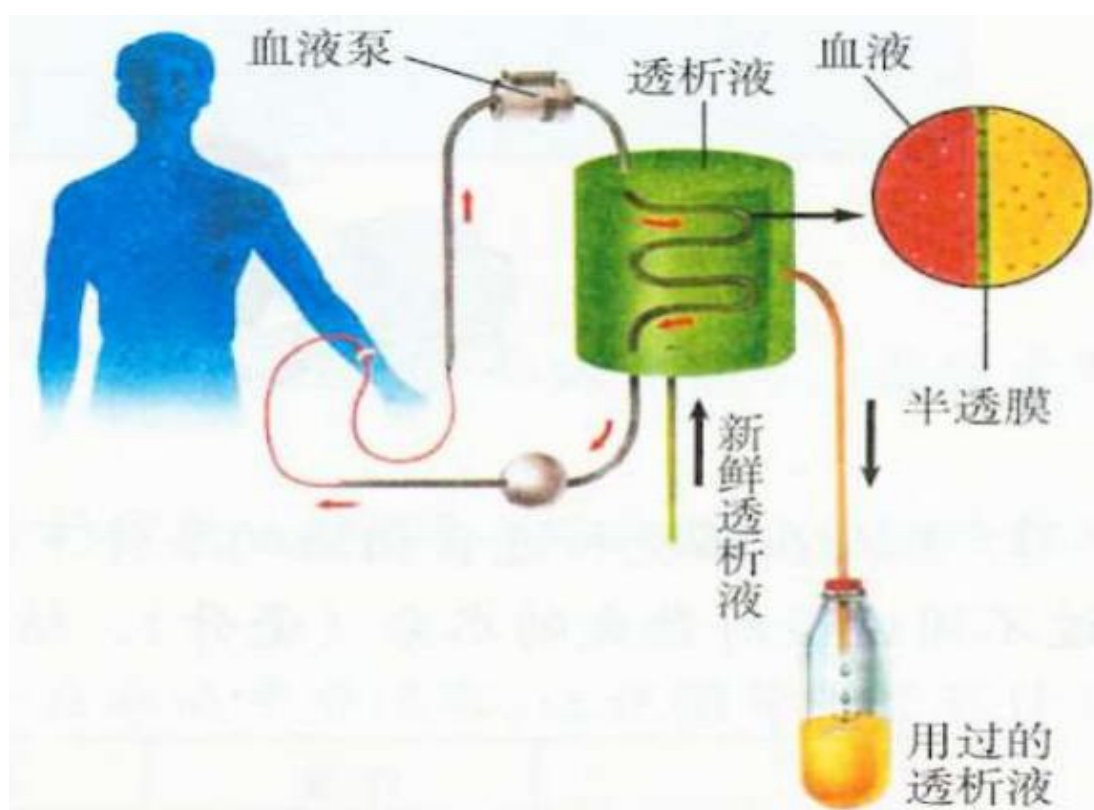
图 2.2-4 血液透析工作原理示意图
