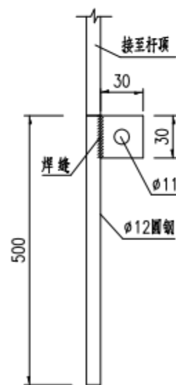
接地端子及引线加工大样
