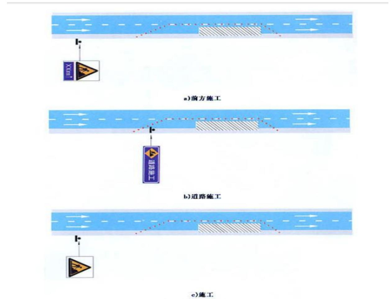
② 在作业区两端设置栏杆，成立交通值班小组，由6人组成，分成两组，每组3人，选一组组长作为机动人员便于指挥交通。每天24小时专人值班，并单向放行通行。使用交通锥型筒及标志牌逐渐封闭施工车道，以便车辆在这个区域内有一定的时间和空间调整车速和位置，准确顺利地穿过施工作业区。
